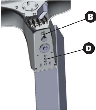
**Step 4** - Hang the luminaire on top bolt. **B**
